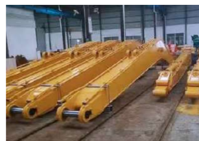
箱梁结构激光焊接
