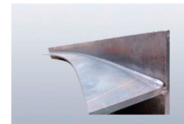
大尺寸船板曲面结构焊接
